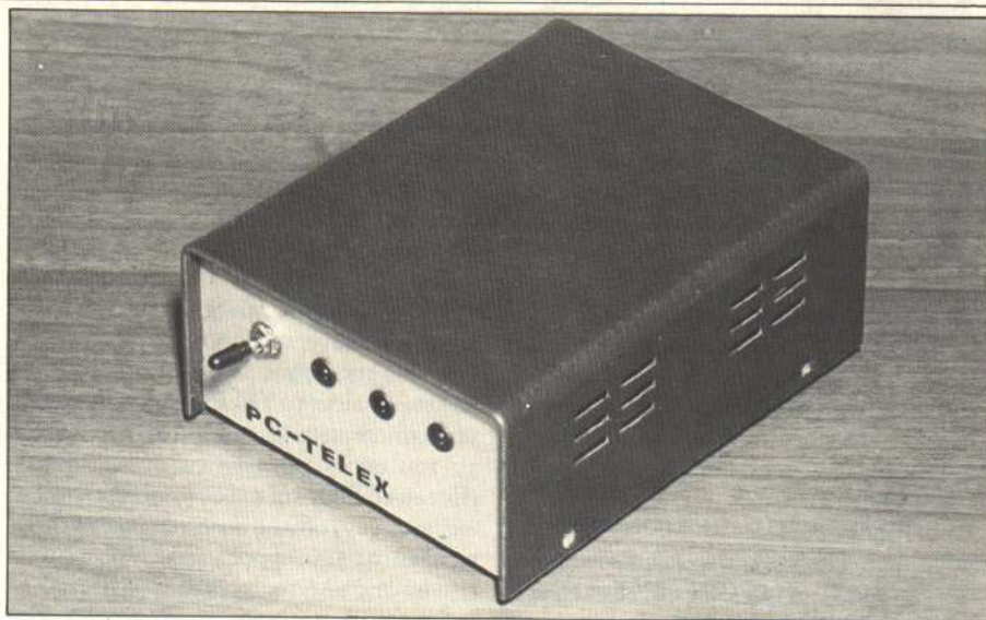
Ένας διακόπτης και 3 leds είναι τα μόνα πράγματα που υπάρχουν στην εμπρόσθια πλευρά του PC Telex
