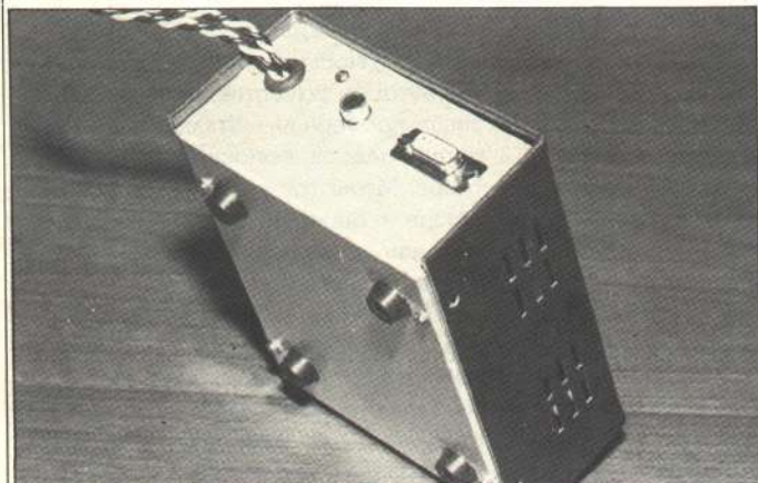
Τα interfaces έχουν τοποθετηθεί στην πίσω πλευρά
